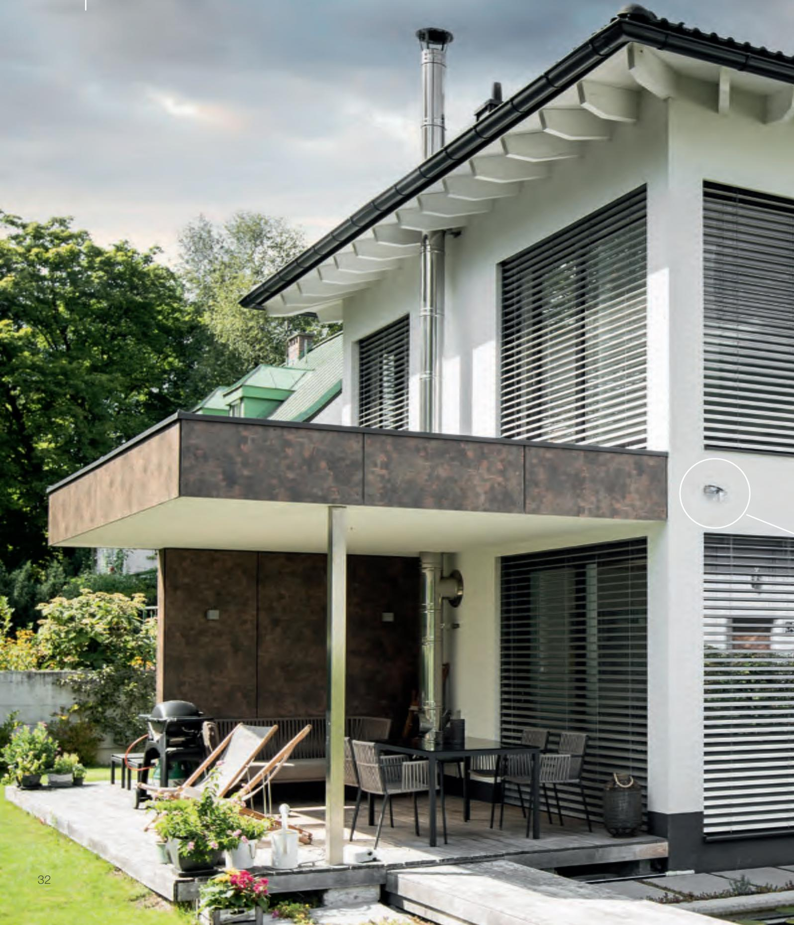
Raffstoren sollten bei Sturm oder hohen Windgeschwindigkeiten stets eingefahren werden. Das passiert bei Schlotterer auf Wunsch ganz automatisch. Mit dem intelligenten Windwächter, der ab einer bestimmten Windgeschwindigkeit das entsprechende Signal gibt. Ein entscheidender Sicherheitsvorteil für Ihren Raffstore, vor allem, wenn Sie nicht zuhause sind.
